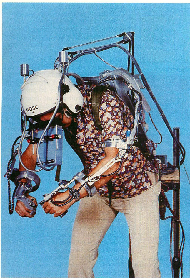
Green man è un teleoperatore che consente a un uomo (a sinistra) di azionare a distanza una stazione di lavoro antropomorfa (a destra). Due telecamere collocate sulla stazione inviano informazioni a schermi in miniatura montati sul casco dell'operatore; viene trasmesso anche il suono. I movimenti della
