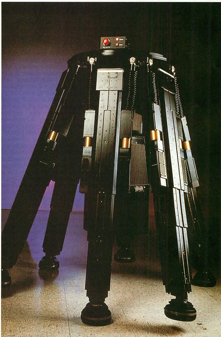
Dotato di telecamere e sensori, il robot Odex TM III realizzato per conto della Commissione per l'energia atomica francese è in grado di spostarsi negli ambienti non accessibili all'uomo di una centrale nucleare e verificare eventuali guasti.
