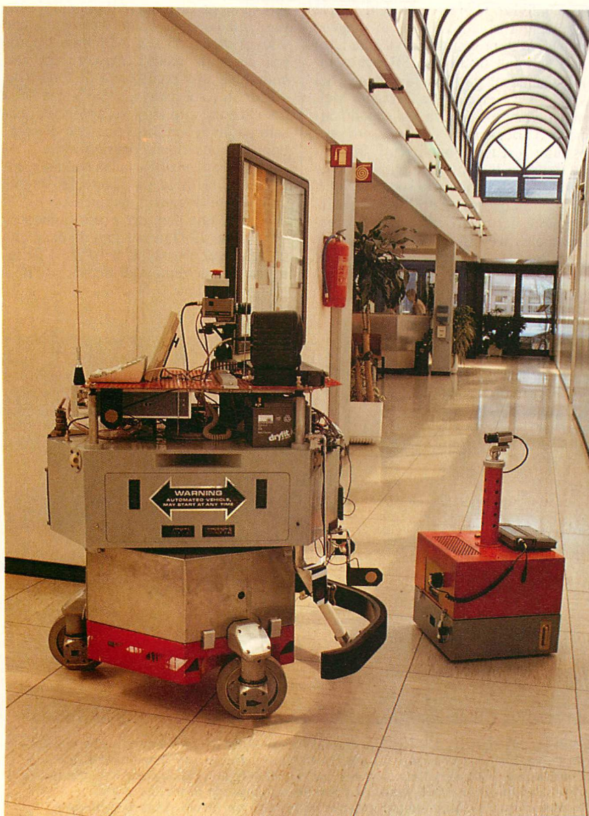
I robot mobili di MAIA sono attualmente due: uno principale (a sinistra), dotato di telecamera e sensori a ultrasuoni e in grado di comunicare a voce con le persone (mediante microfono e altoparlante), e un secondo robot più piccolo (a destra), usato per funzioni speciali (come la sorveglianza dell'Istituto) e per la sperimentazione di nuove tecniche di navigazione.
