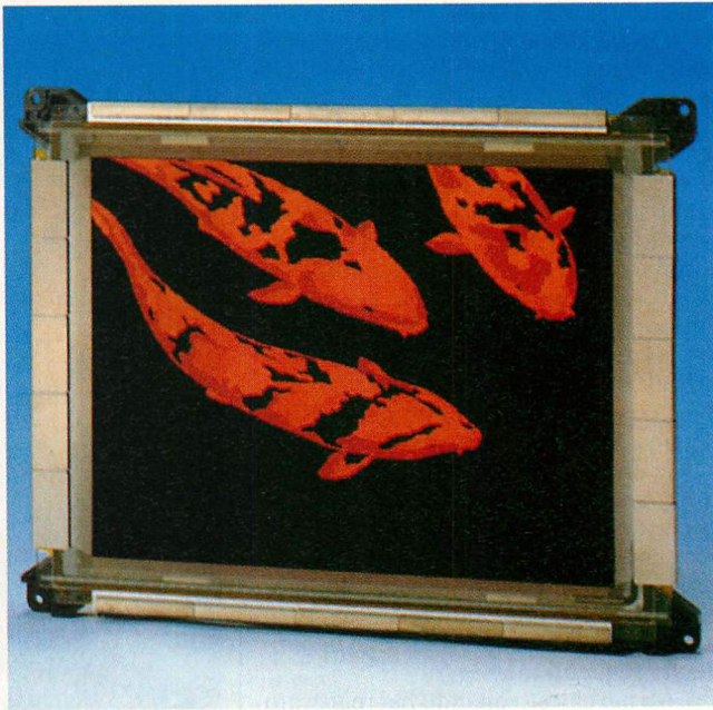
Gli schermi piatti, come il visore a cristalli liquidi della IBM (a sinistra) e il visore a plasma della Fujitsu (a destra), sono considerati indispensabili per i calcolatori portatili di forma compatta. Le future macchine dovranno consumare meno energia delle attuali.
