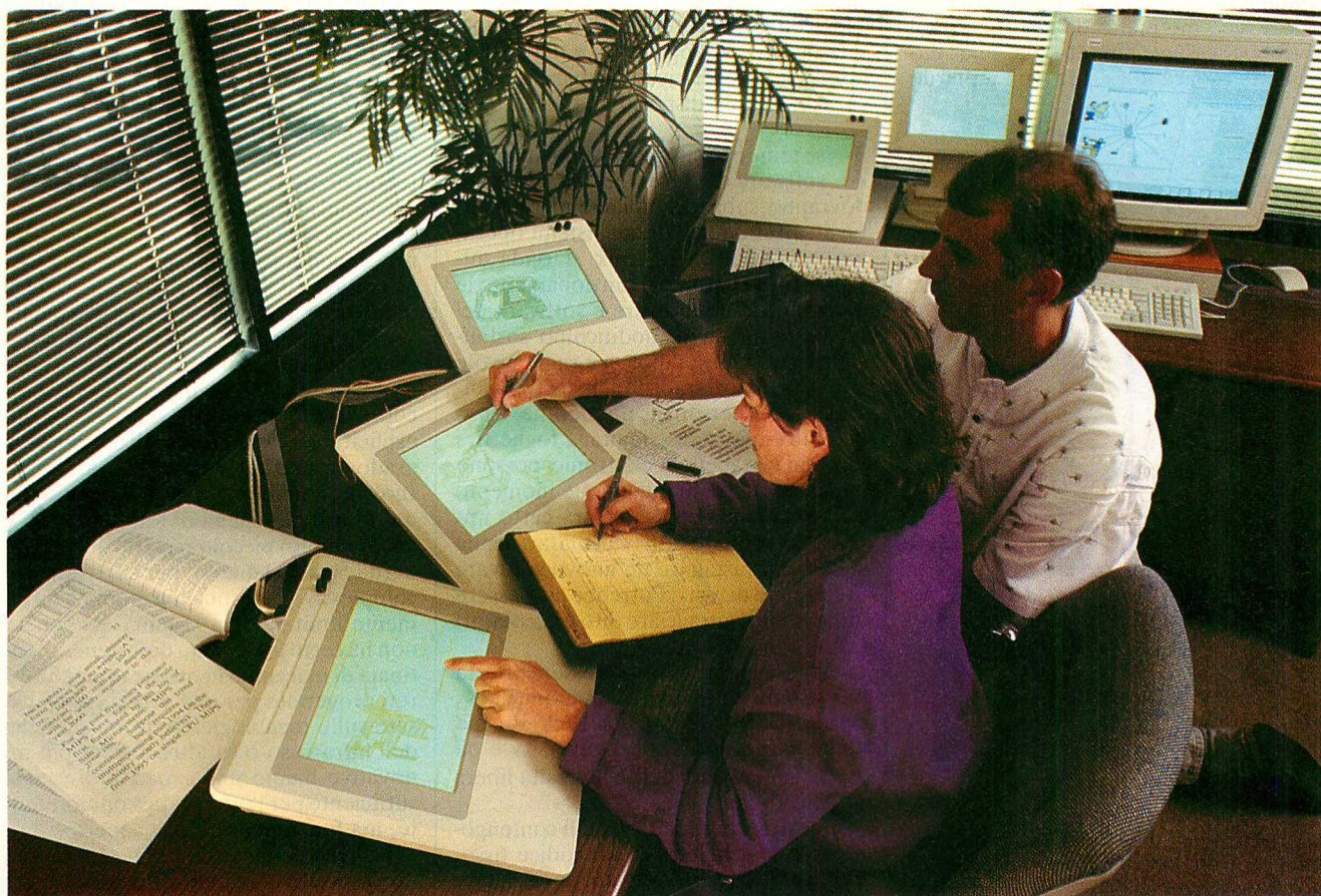
In questo ufficio del Centro di ricerche della Xerox a Palo Alto, i taccuini elettronici da brutta copia ampliano il tradizionale schermo. I prototipi dei taccuini sono collegati ai calcolatori tradizionali; finora sono stati costruiti solo pochissimi modelli senza fili.
